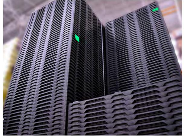
Tipo de Entrada: Patín Hidráulico y Montacargas por los 4 lados
